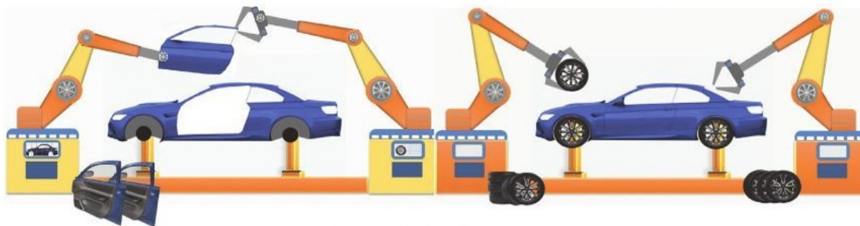
Hình 11.2. Mô hình dây chuyền lắp ráp ô tô sử dụng robot
